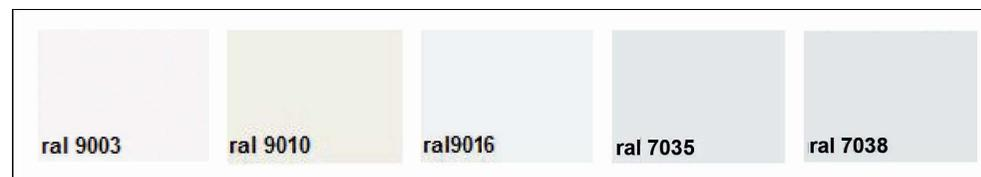
Figure 18 : Principales références RAL utilisables par les constructeurs d'éoliennes.
